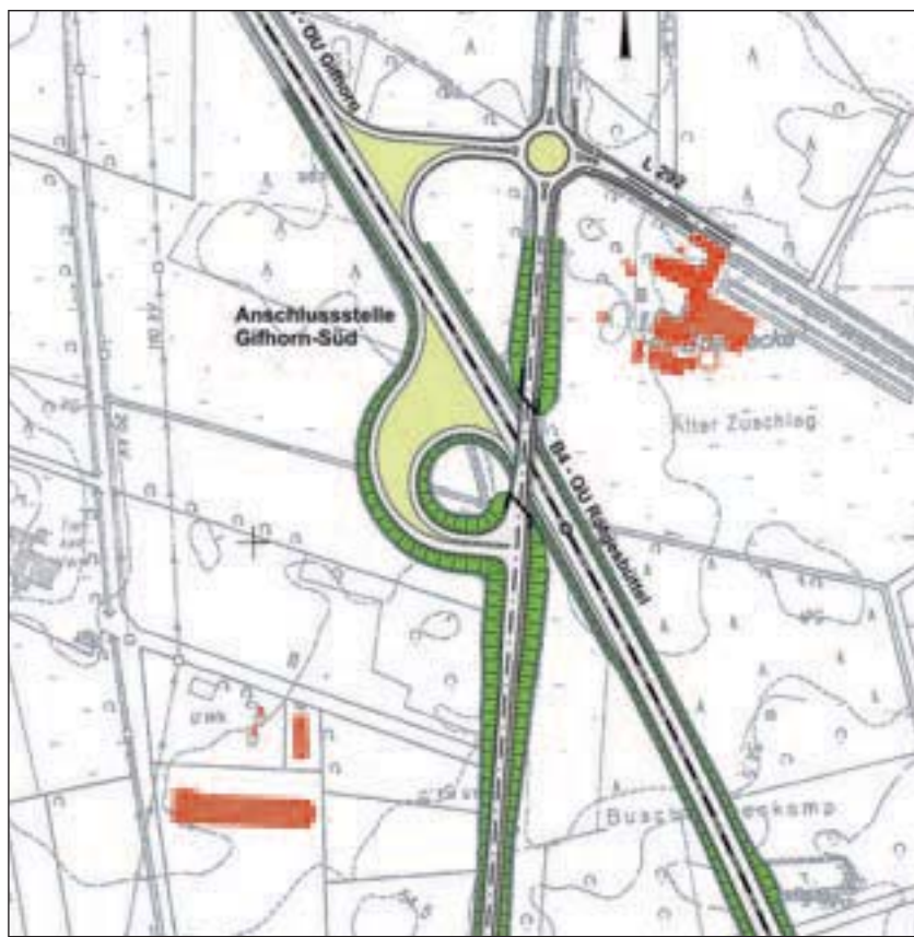
So sieht der große Knotenpunkt Gifhorn Süd der neuen B 4 mit zwei Landesstraßen, alter B 4 und Bahnlinie aus: Kreisel und Rampe sorgen für freie Fahrt.
